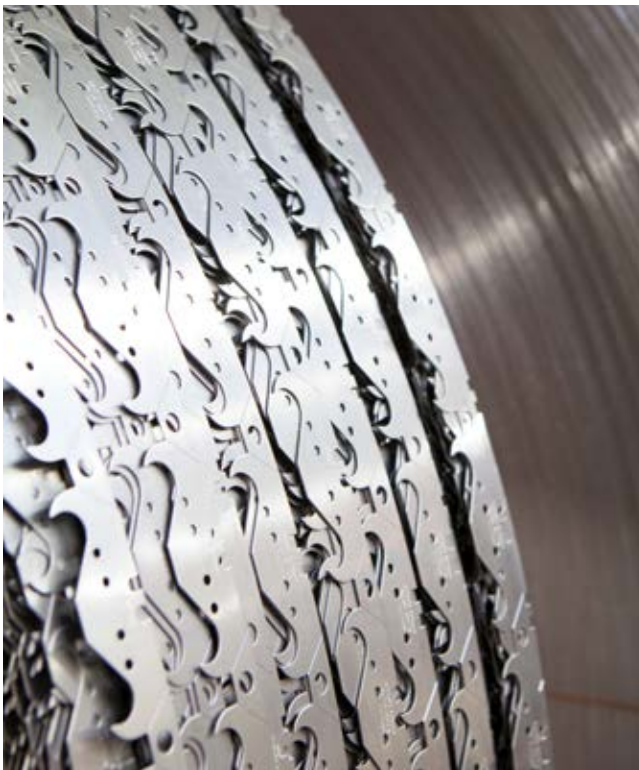
Das Bild zeigt aufgewickelte Hakenklingen zum Beginn des Produktionsprozesses.
